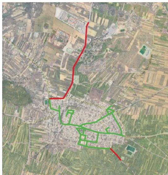
Εικόνα 60. Προτεινόμενες επεκτάσεις δικτύου προσβάσιμων διαδρομών στα Σπάτα. Με πράσινο χρώμα απεικονίζεται το μελετούμενο δίκτυο προσβάσιμων διαδρομών του παρόντος Σ.Α.Π. και με κόκκινο απεικονίζονται οι μελλοντικές προτεινόμενες επεκτάσεις.
